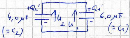
La charge initiale de  $Q$ , placée sur l'armature supérieure du condensateur de  $6,0 \mu\text{F}$  est maintenant répartie sur les 2 armatures supérieures des 2 condensateurs:
