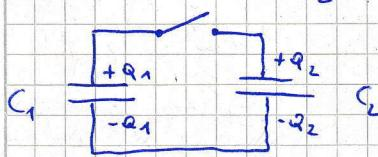
au départ, les charges portées par les plaques ne sont pas les mêmes, car aucun contact se fait dans le circuit.
