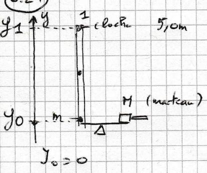
• la force du marteau et la force de frottement sont des forces non conservatives. C'est le travail de ces 2 forces qui fait varier l'énergie mécanique de m:
