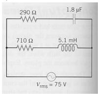
Dans la situation ci-dessous, le générateur délivre un courant 4 fois plus grand à très basse fréquence par rapport au courant délivré à très haute fréquence. Trouver le rapport  $R_1/R_2$  des résistances.
